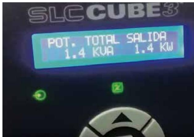
Potencia total demandada por un radar modernizado: 1.4 kW. El radar original demandaba 20 kW.
