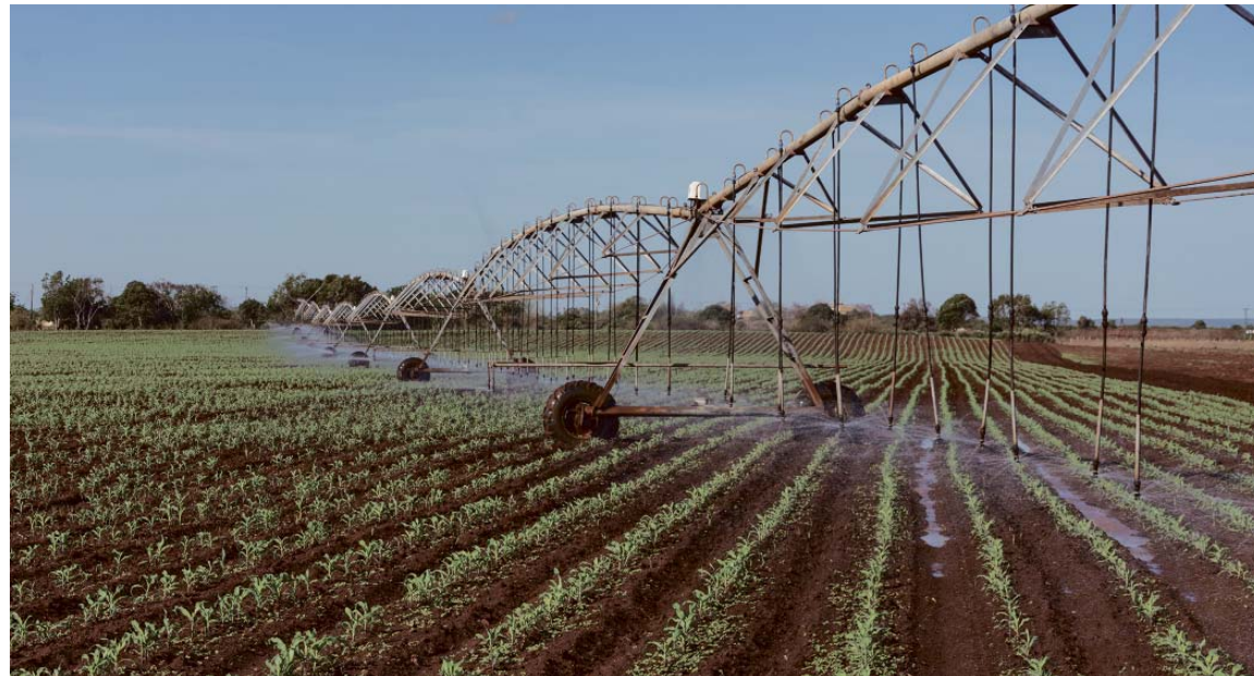
Esta máquina puede irrigar en seis horas un cuadrante de cultivos, mediante agua de un pozo que suministra 85 litros por segundo.
