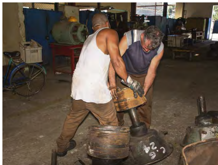
Montaje de una polea reparada de la combinada cañera KTP.
