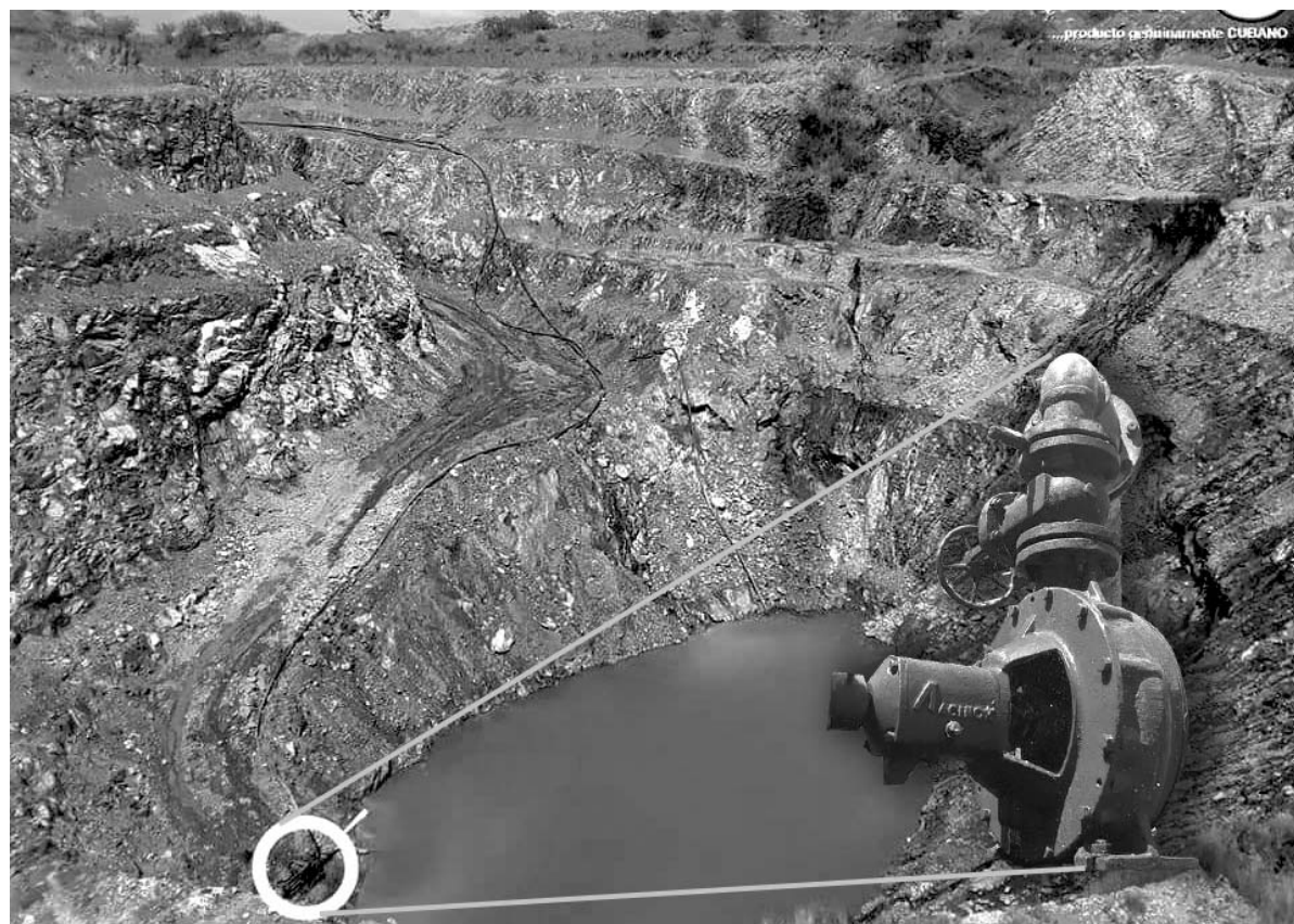
La bomba debe extraer agua a casi 70 metros de profundidad en el fondo del vaso de la mina de cromo.
