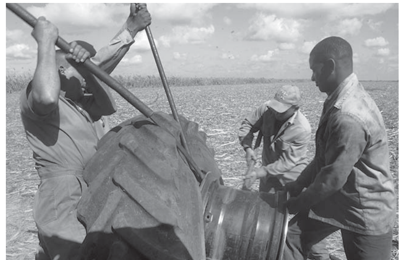
Coger un ponche y cambiar un gran neumático de combinada en plena guardarraya, además de un avezado ponchero, precisa del esfuerzo de mecánicos, operadores, y del colectivo del pelotón, todos vinculados salarialmente a los resultados productivos.
