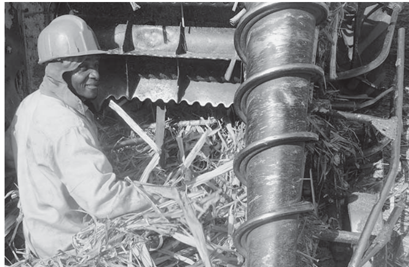
Pablo Fis, padre, y operador de KTP, desatora su máquina de la caña “acostada” que se enredó con bejucos y otras maniguas de campos sin cultivar debidamente.
