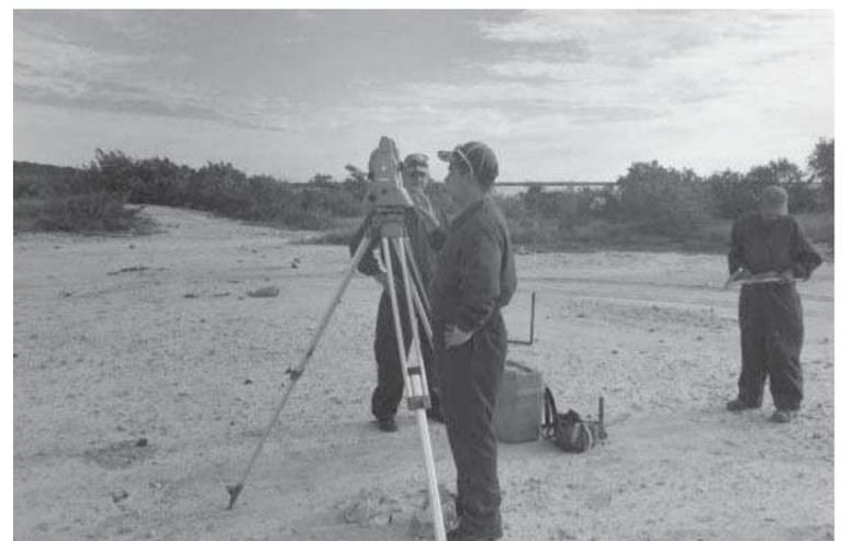
Estaciones totales para el levantamiento topográfico.
