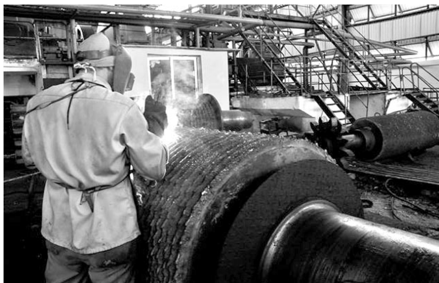
La adición a las mazas de los picotes o dientes de sierra elevará la eficiencia en los molinos: más azúcar y menos atoros de caña.
